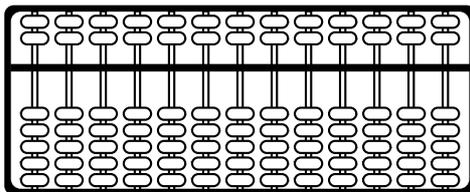
Chaque tige du soroban comporte une boule dans la partie supérieure et quatre boules dans la partie inférieure.
